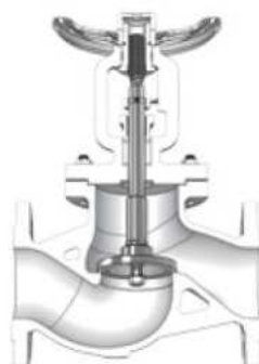
Otturatore equilibrato Balanced disc
